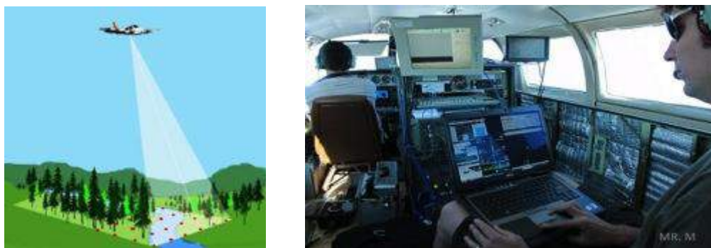
Figure 4 : Projection de lumière laser au sol (© Suratno)- Equipement embarqué (© PHCF)
